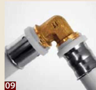
05 ... kann überprüft werden, wie weit das Rohr in die Presshülse eingedrungen ist. Das Rohr muss hier unbedingt sichtbar sein.
